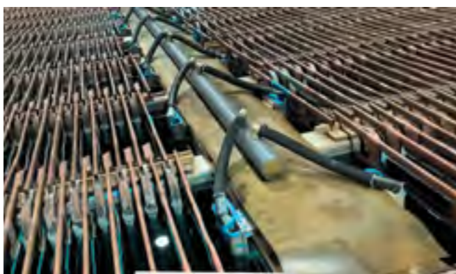
Подача электролита для производства меди.
